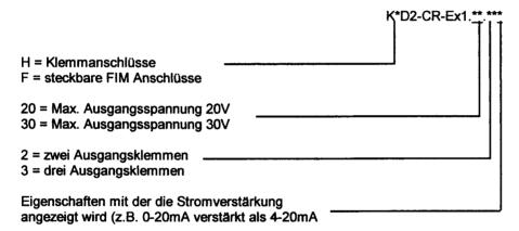
Die Typnummern mit einem Buchstaben 'P' zeigen an, daß die Geräte die Option haben Power Rail Anschlüsse (+ & -) anstelle von Klemmen 11 & 12 zu verwenden, wie z. B. K\*D2-CR-Ex1.P.\*\*.\*\*\*
