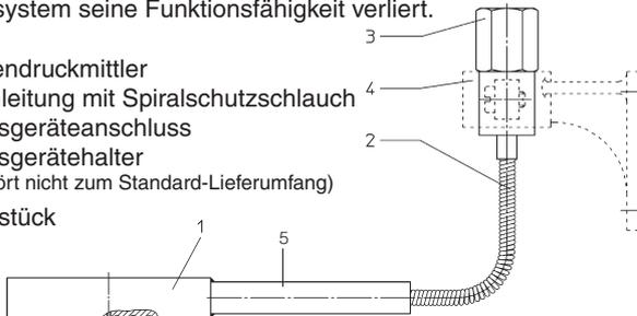
Der Druckmittler wird zwischen Spannflansch und Messstellenanschlussflansch eingebaut.
